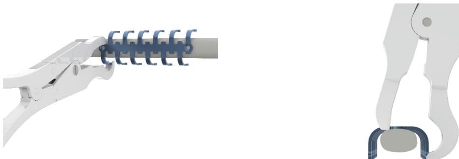
Com a placa de fratura assimétrica Marlexfix posicionado na costela, aproxime a alicates de modo que a mandíbula menor seja posicionada próximo a barra central (alma) da placa e a mandíbula maior na extremidade da perna.
